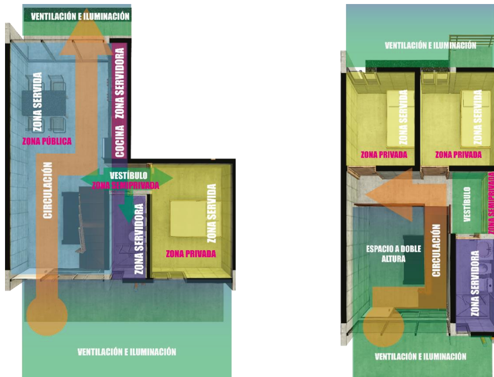
Figura 26: Diagrama Ilustrativo de la funcionalidad en planta baja (izquierda) y planta alta (derecha) dentro de la tipología 3 de la vivienda colectiva Castillo 3902
