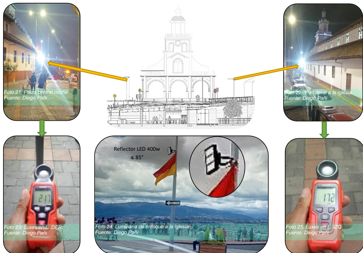
Figura 12. Reflectores que iluminan la fachada de la iglesia
