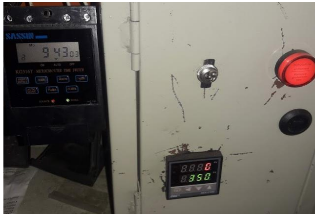
Fig. 13: Configuración de tiempo y temperatura del horno para el proceso de pirólisis
