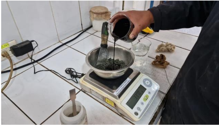
Ilustración 14. Compactación de los agregados con el ligante asfáltico
