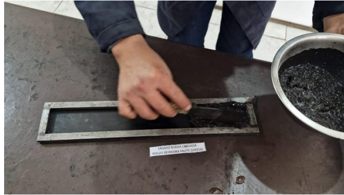
Ilustración 39. Aplicación de la lechada asfáltica sobre la placa
