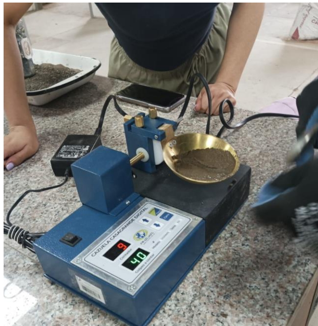
Ilustración 5 Determinación del límite líquido con ayuda de la máquina “casa grande”
