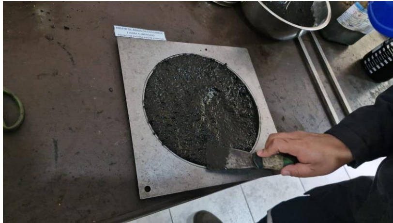
Ilustración 36. Curado de la muestra a condiciones de temperatura y humedad controlada
