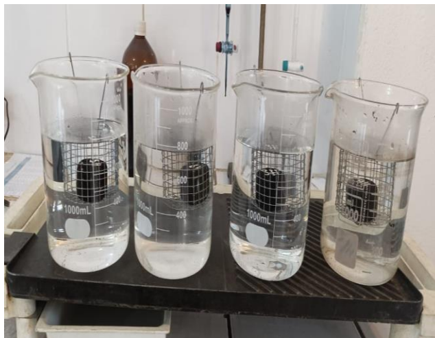
Ilustración 43. Dejar las muestras en un periodo de condicionamiento
