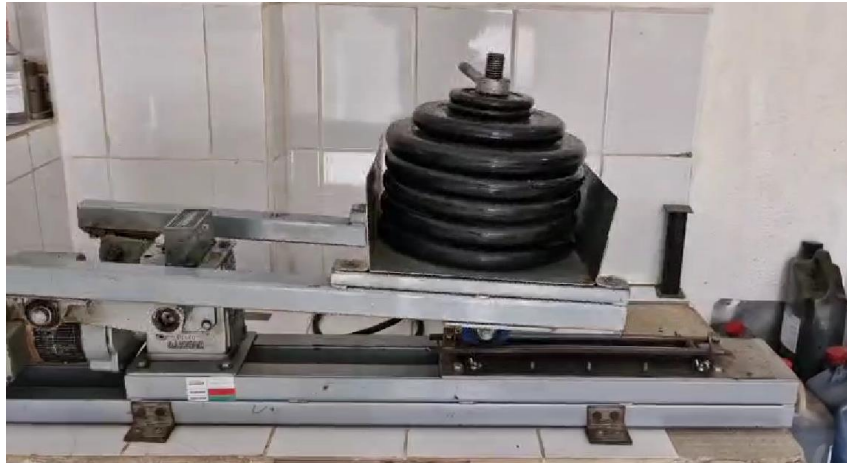
Ilustración 41. Ensayo de rueda cargada
