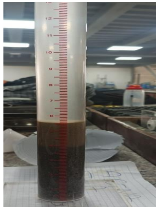
Ilustración 12. Reposo de la muestra para equivalente de arena
