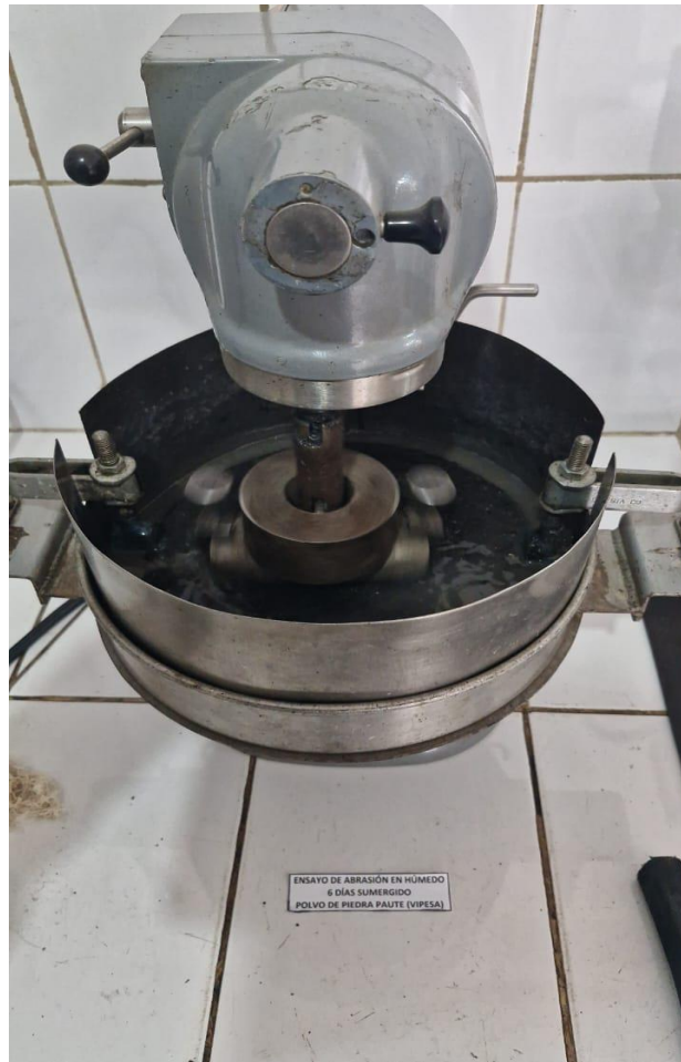
Ilustración 38. Ensayo de abrasión en húmedo
