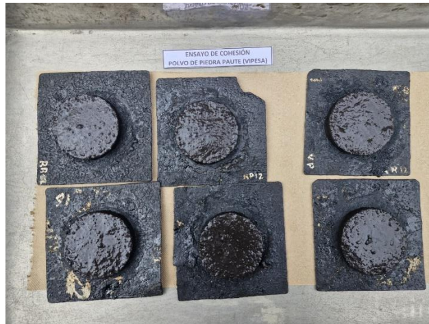
Ilustración 30. Colocación de muestras a temperatura
