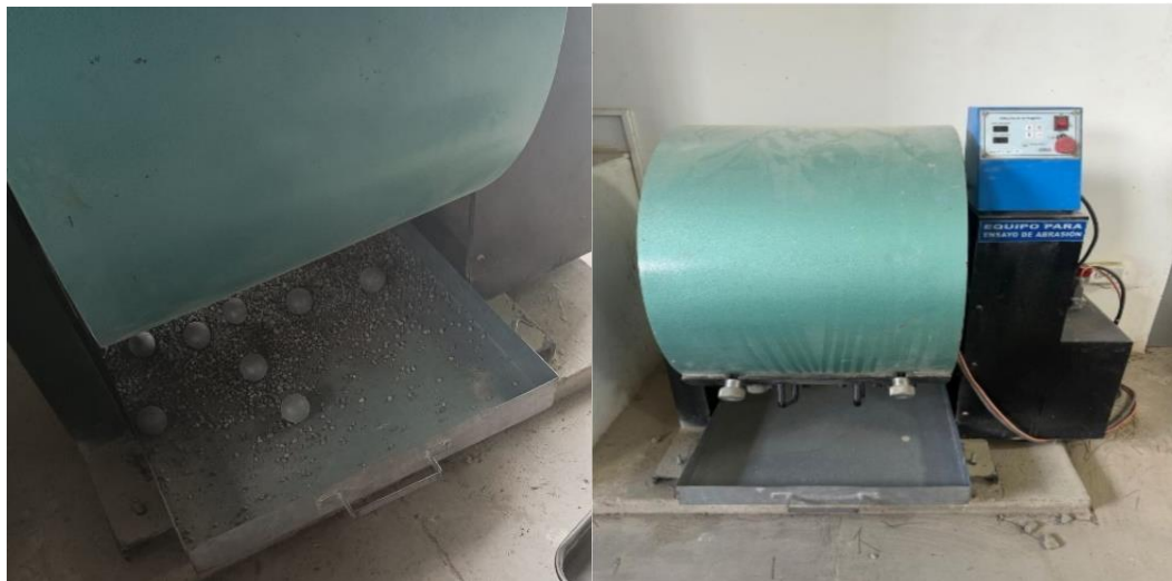
Ilustración 7. Ensayo con máquina de los Ángeles
