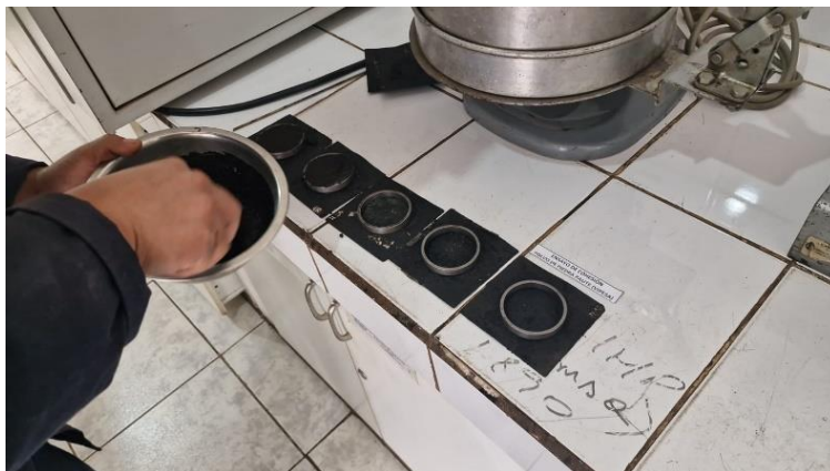
Ilustración 29. Preparación y compactación de las muestras asfálticas
