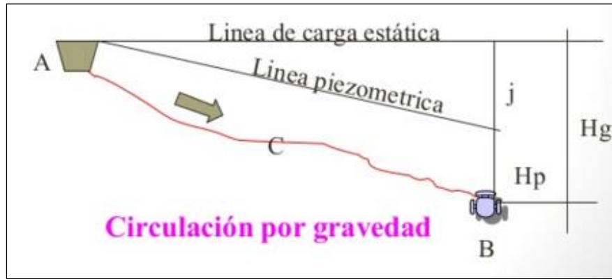
Fig. 7: Línea de carga estática y piezométrica
