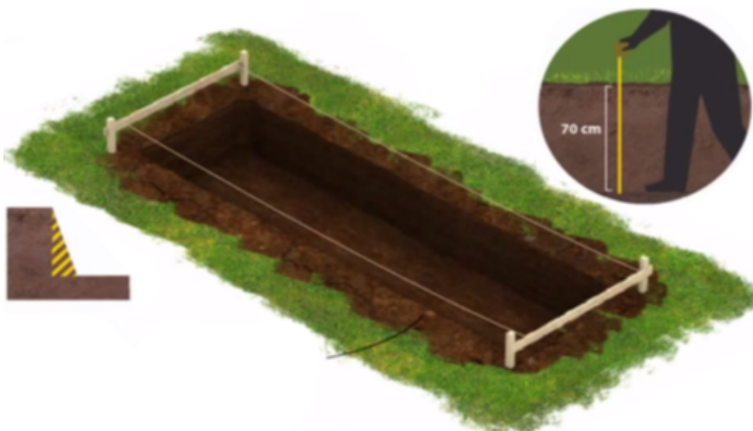
FIGURA 3.11: Proceso constructivo de una biojardinera “c” Fuente: https://www.youtube.com/watch?v=kSFGruGQkTI Elaboración y Adaptación: Fabrizio Benenaula.
