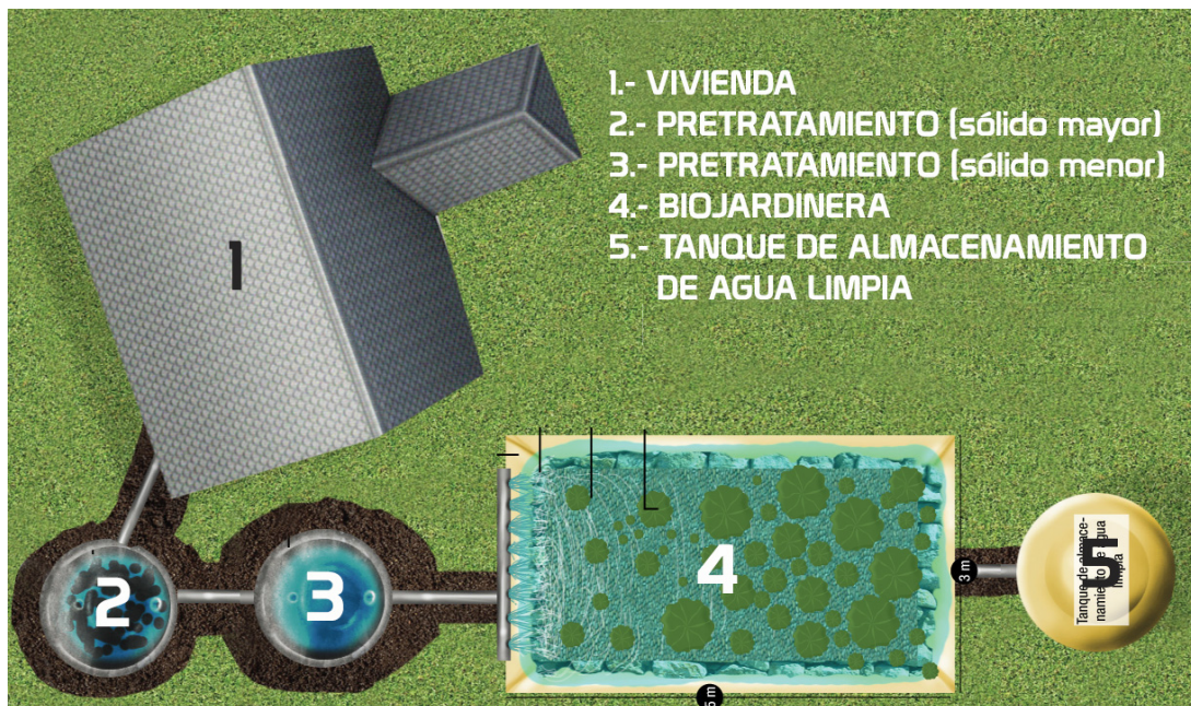
FIGURA 1.28: Diagrama de aguas grises de una vivienda. Fuente: http://aula.aguapedia.org/mod/resource/view.php?id=553
