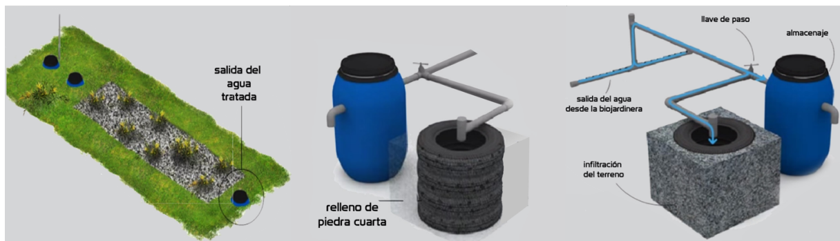
FIGURA 3.18: Proceso constructivo de una biojardinera “j” Fuente: https://www.youtube.com/watch?v=kSFGruGQkTI Elaboración y Adaptación: Fabrizio Benenaula.
