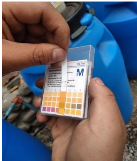
Figura 21. Medición del pH tomado a los 60 días en campo y en laboratorio del primer biodigestor (manual). Fuente:Elaboracion propia.
