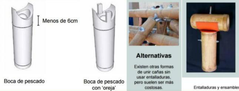
IMAGEN 26: Uniones Boca de Pescado y otras alternativas
