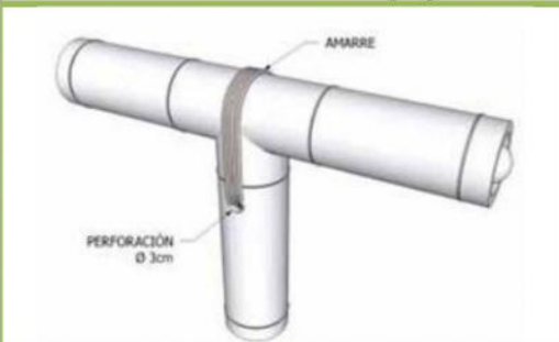
IMAGEN 29: Amarre de unión perpendicular
