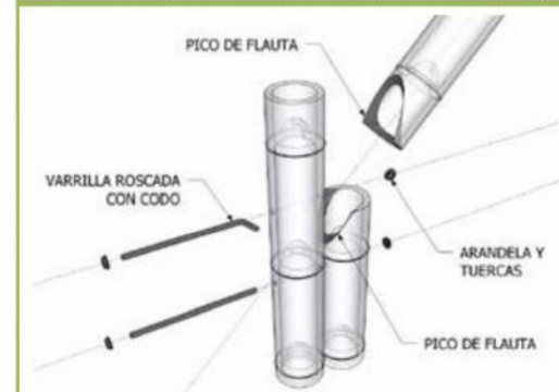
IMAGEN 31: Refuerzo en la unión diagonal
