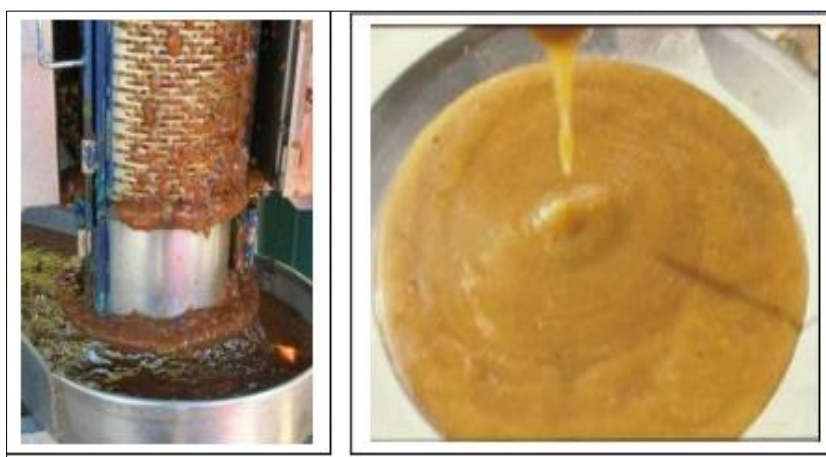
Figura 5. Desmucilaginator y mucílago obtenido del beneficio del fruto Fuente: (Valencia y Alama, 2009)
