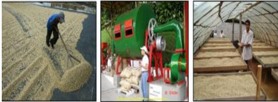
Figura 8. Remoción de humedad del café Fuente: (IICA, 2010)
