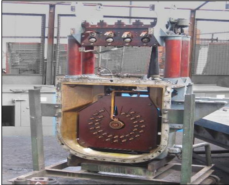
**Figura 13. OLTC en el interior de un transformador.**
