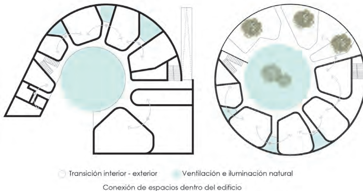
FIGURA 1.44: Iluminación y ventilación natural
