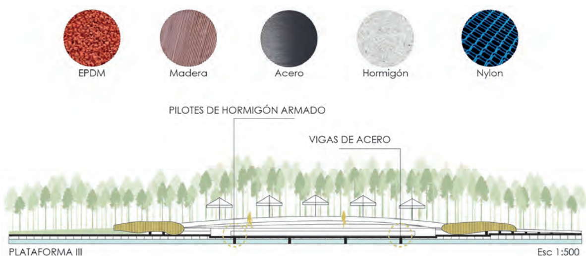
FIGURA 1.53: Materialidad y técnicas constructivas Orilla del Lago Paprocany
