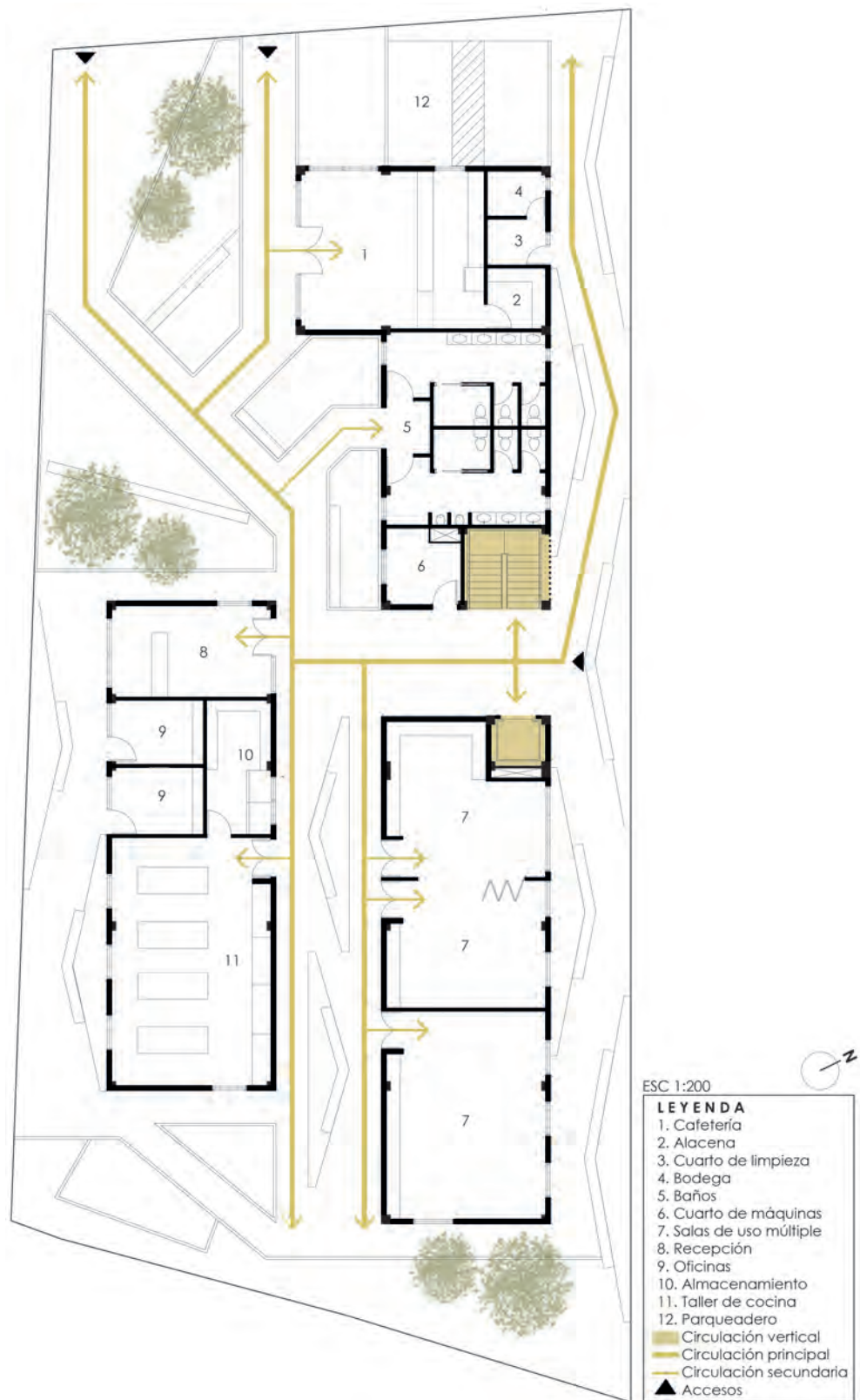
FIGURA 4.9: Planta baja equipamiento multiservicio
