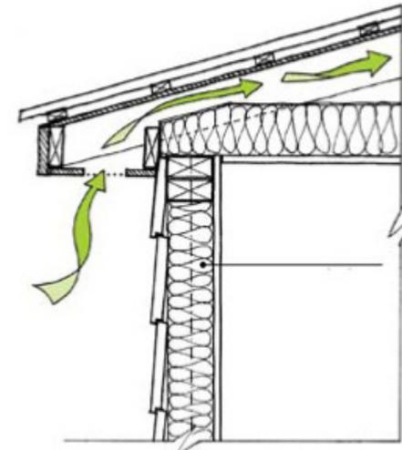
Fig. 47 Aislación térmica continua.
