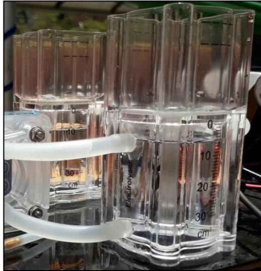
*Ilustración 21. Tanques de almacenamiento de gas del Sistema Junior Basic J101 del Centro de Investigación en Energías Renovables (CER) de la Universidad Católica de Cuenca
