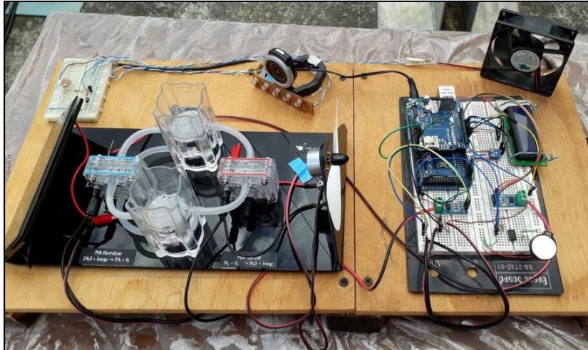
*Ilustración 24. Sistema Junior Basic J101 del Centro de Investigación en Energías Renovables (CER) de la Universidad Católica de Cuenca y Sistema de Medición y Recolección de Datos
