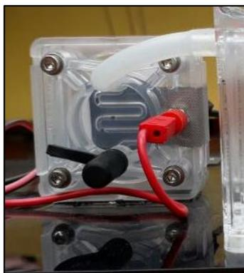
Ilustración 20. Electrolizador del Sistema Junior Basic J101 del Centro de Investigación en Energías Renovables (CER) de la Universidad Católica de Cuenca
