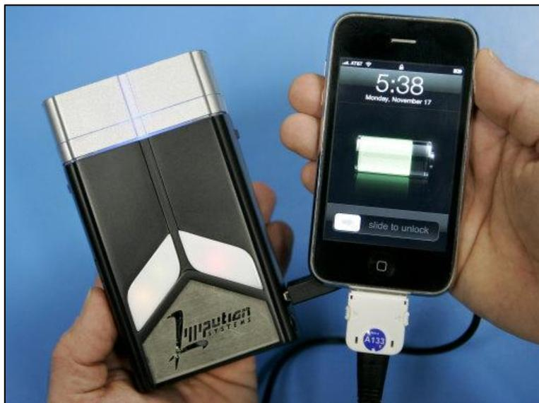
*Ilustración 8. Pilas de combustible para equipos electrónicos
