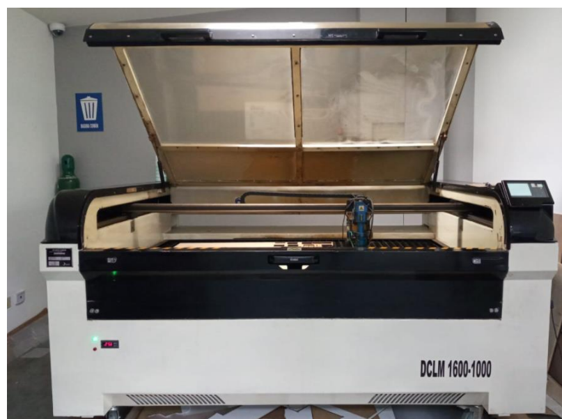
Figura 12. Cortadora y grabadora láser Fuente: Laboratorio Fab Lab-Ucacue
