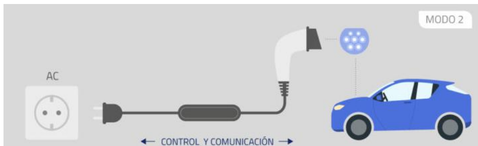
Figura 7. Modo de carga 2 Fuente: (Ormazabal, 2024)
