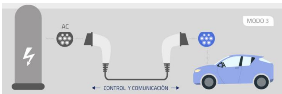
Figura 8. Modo de carga 3 Fuente: (Ormazabal, 2024)
