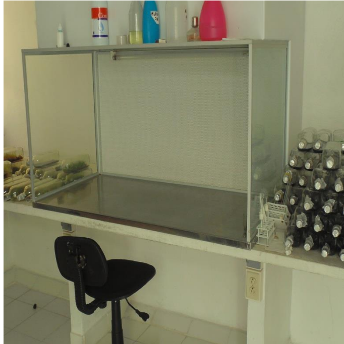
Fig. 14A. Cámara de flujo laminar Elaboración propia
