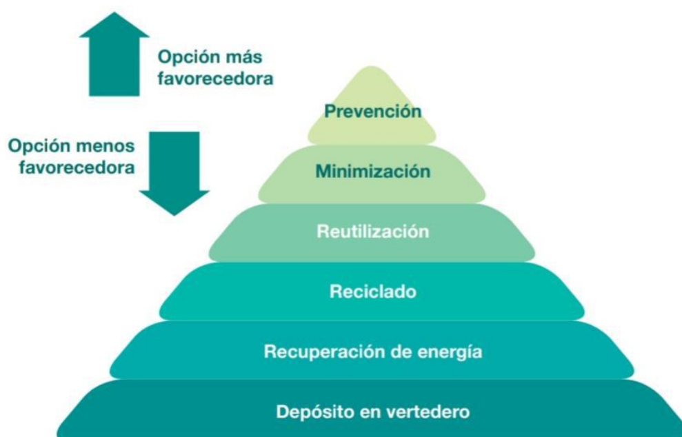
FIGURA 1.6: Jerarquía de las Acciones de Gestión para la Minimización de los Residuos
