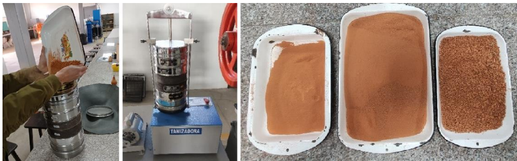
FIGURA 2.3: Tamizado del Material Triturado
