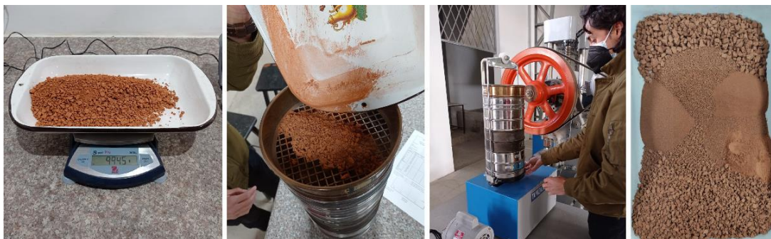
FIGURA 2.6: Ensayo Granulométrico de los Áridos
