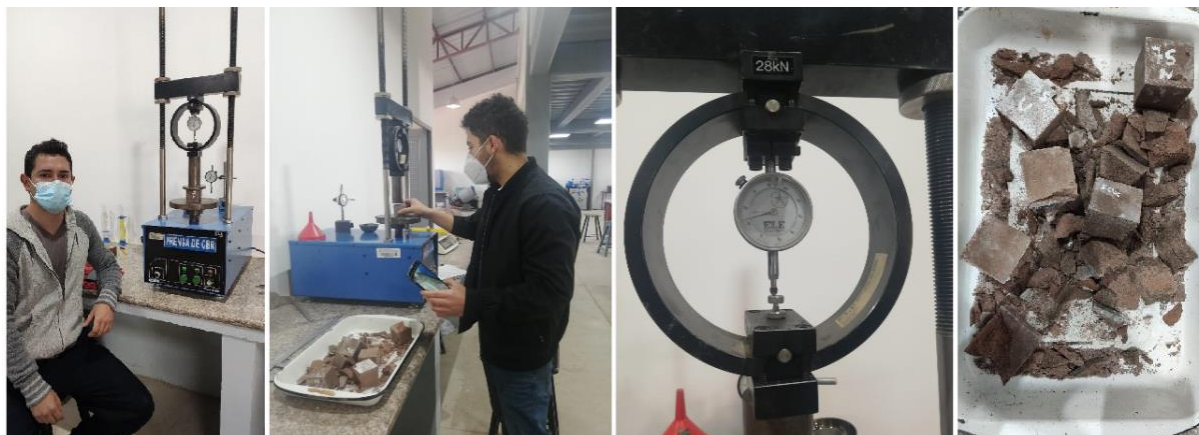
FIGURA 2.9: Ruptura de Probetas a Compresión
