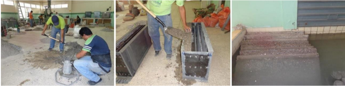
FIGURA 1.18: Proceso de Moldeo y Curado de los "Muros Prefabricados en Base a RCD Mixto"
