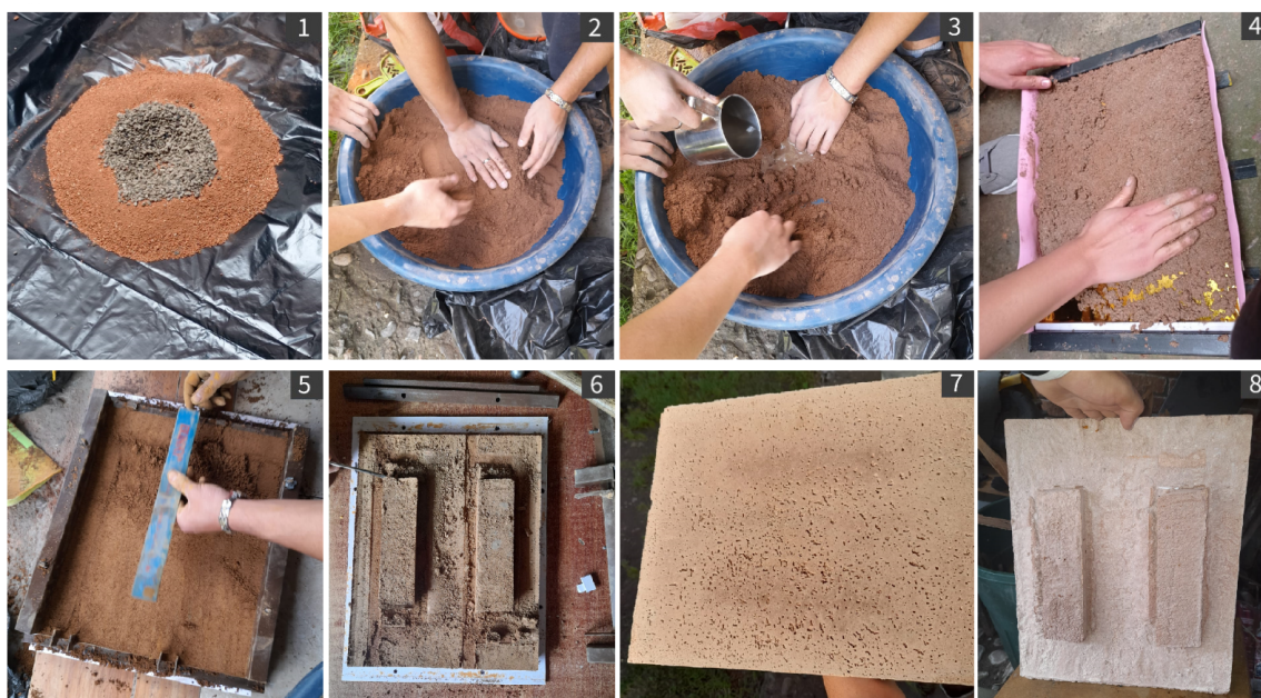
FIGURA 2.15: Proceso Exitoso de Fabricación de Panel
