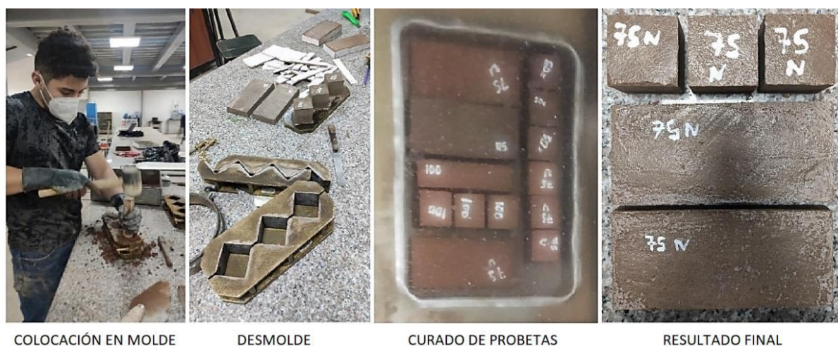
FIGURA 2.8: Elaboración de las Probetas para el Ensayo de Compresión
