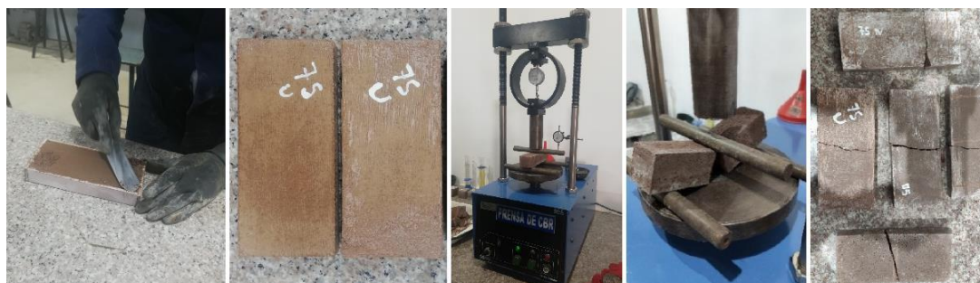
FIGURA 2.12: Ruptura de Probetas a Flexión
