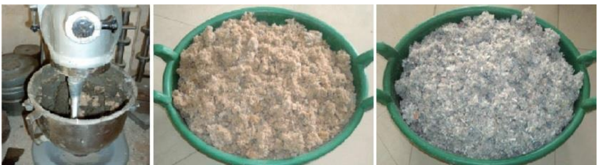
FIGURA 1.26: Homogeneización de los Residuos
