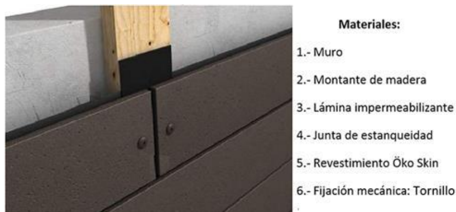
FIGURA 1.21: Elementos del Sistema de Anclaje de Fachada de Hormigón Reforzado con Fibra de Vidrio
