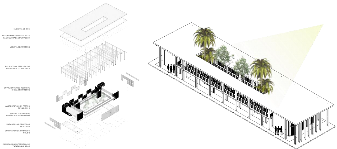
Figura 24: Axonometría-Detalle de los materiales de Centro Comunitario
