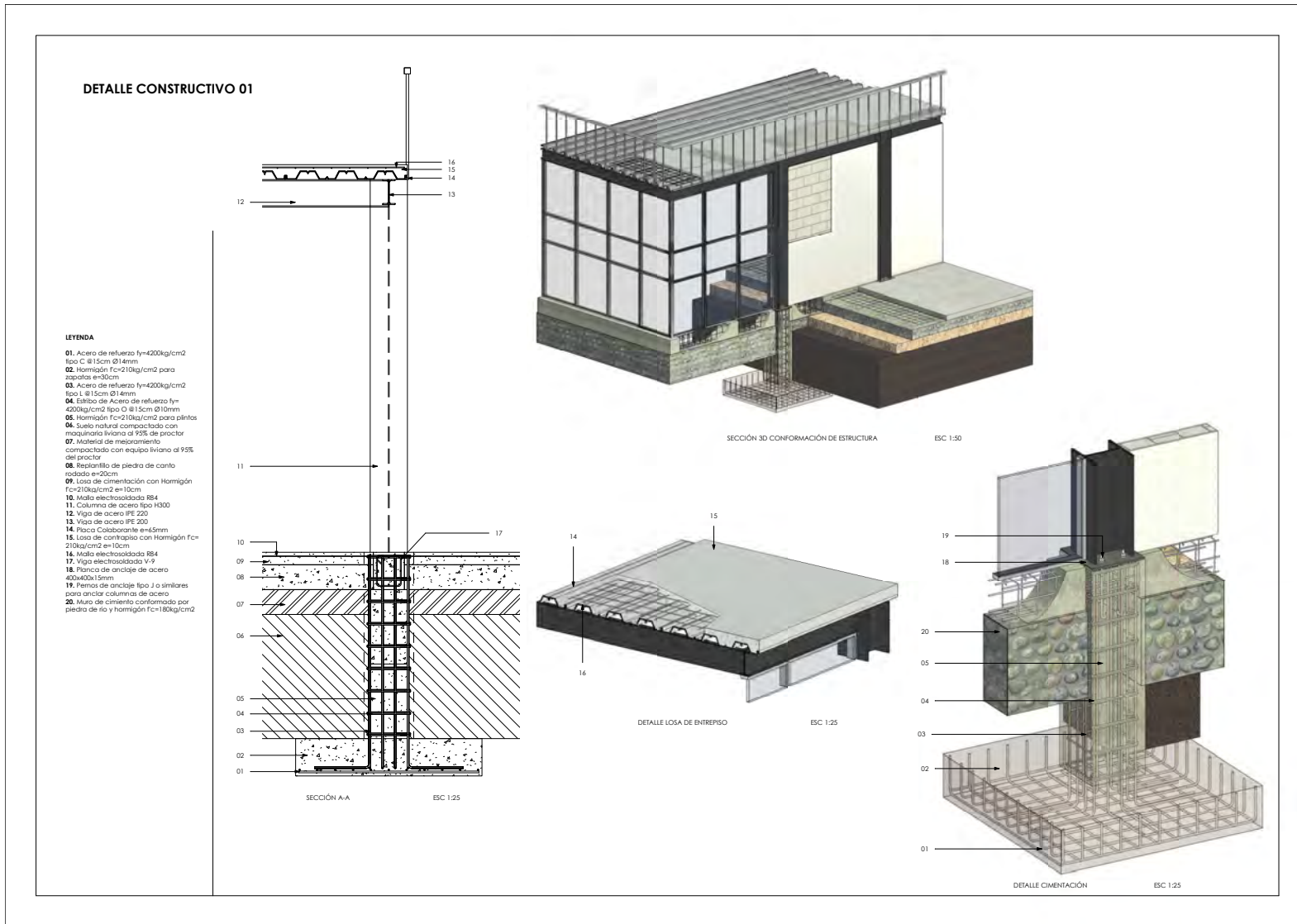
FIGURA 4.29: Detalle constructivo 01. Fuente: Elaboración propia
