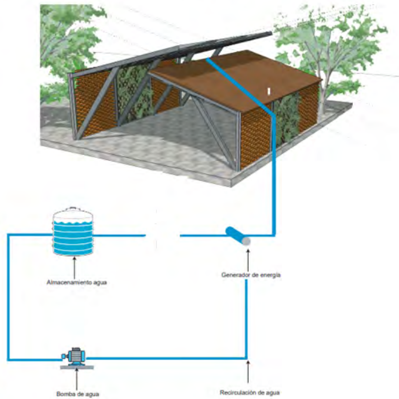
FIGURA 4.10: Esquema de techo espacios varios. Fuente y elaboración: propia.
