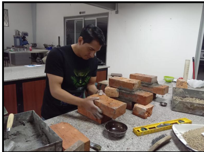
Figura 42: Montaje de ladrillos
