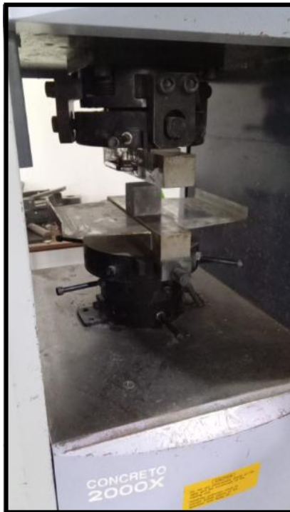
Figura 39: Ruptura de cubos
