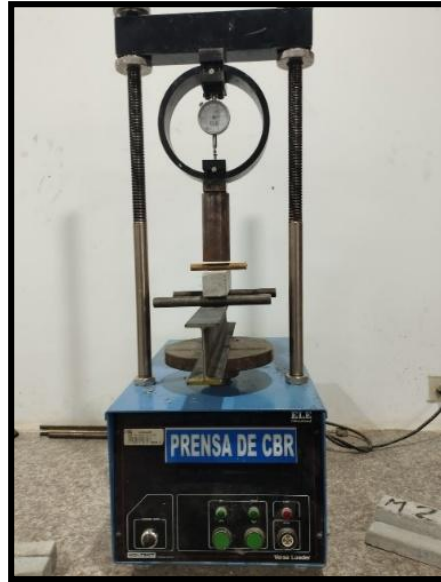
Figura 13. Prensa de compresión de baja capacidad
