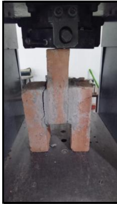
Figura 48: Ruptura de junta
