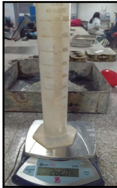
Figura 24: Peso del agua en una probeta
