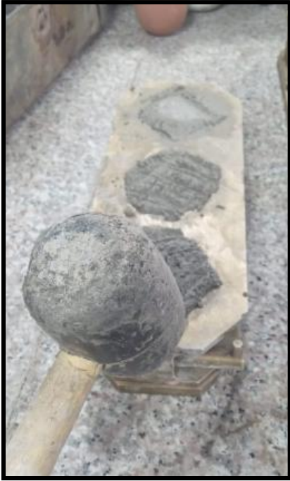
Figura 32: Golpes para una mejor compactación
