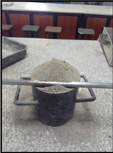
Anexo 7. Árido colocado en probeta y pesado
