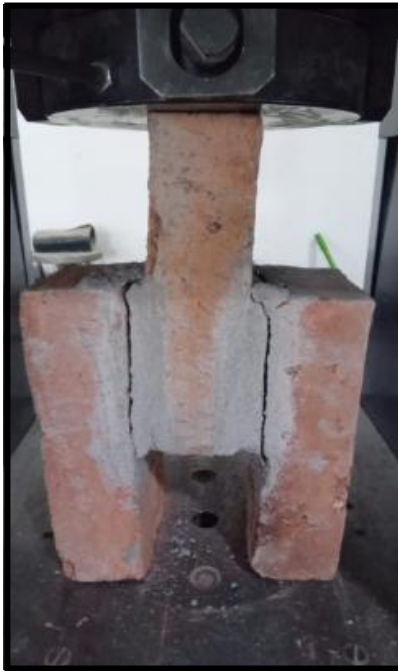
Figura 46: Ruptura de junta
