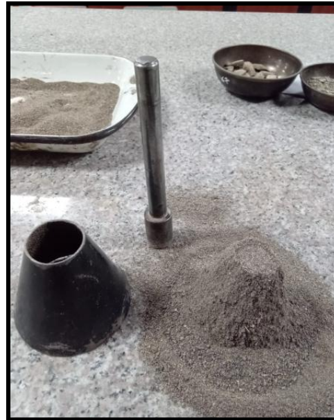
Figura 22: Molde cónico, para saber el estado del árido
