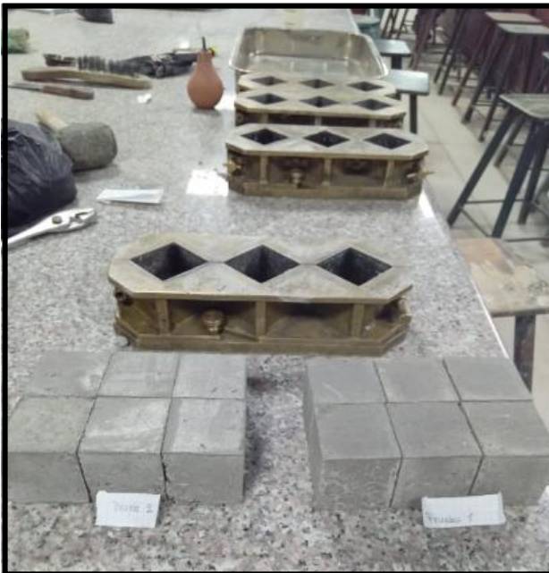
Figura 34: Desmolde de cubos
