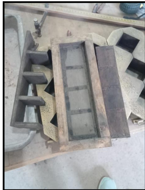
Anexo 12. Probetas 5x5x5 de madera y cobre
