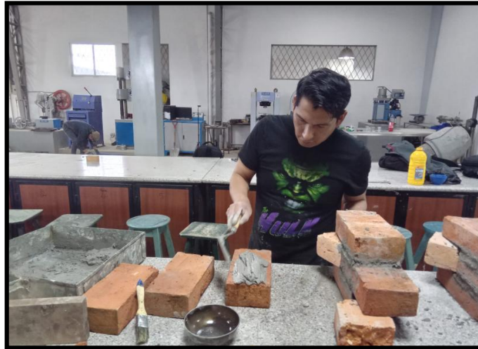
Figura 41: Pegado de ladrillos
