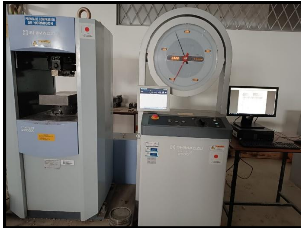
Figura 12. Prensa japonesa SHIMADZU CONCRETO 2000X
