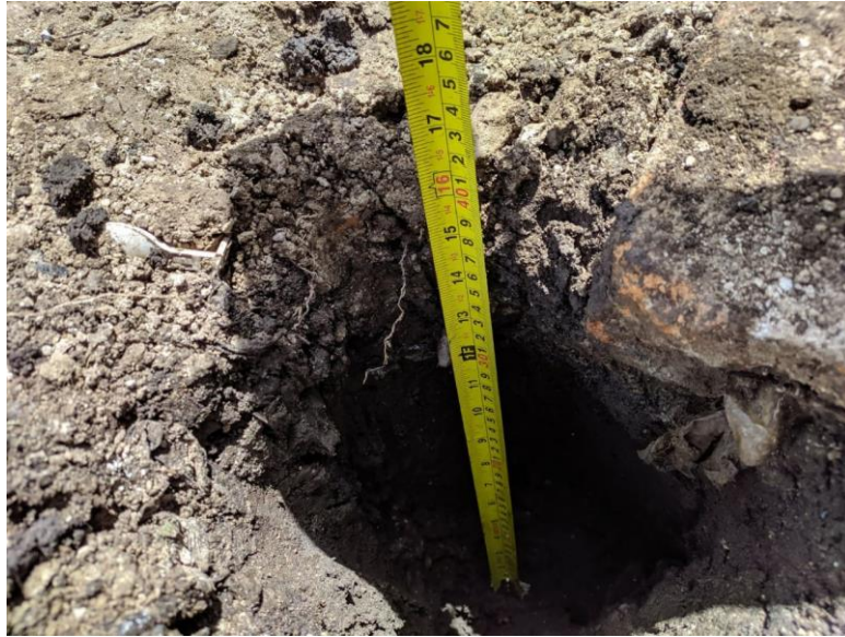
Figura 13: Profundidad para la toma de muestras
