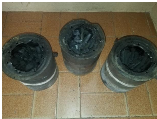
Figura 26: Biochar obtenido luego del proceso de enfriamiento
