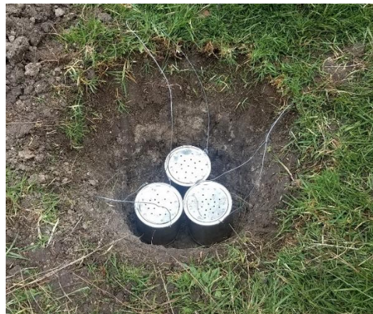
Figura 19: Acondicionamiento de las entradas de aire del tambor externo
