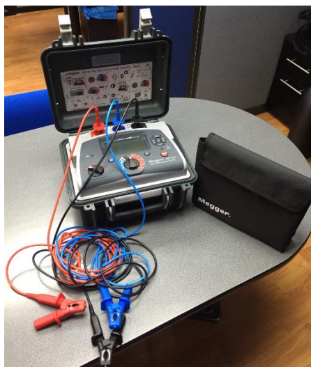
Equipo marca Megger, de 10 TΩ en modelos de 5 kV y 20 TΩ en modelos de 10kV
