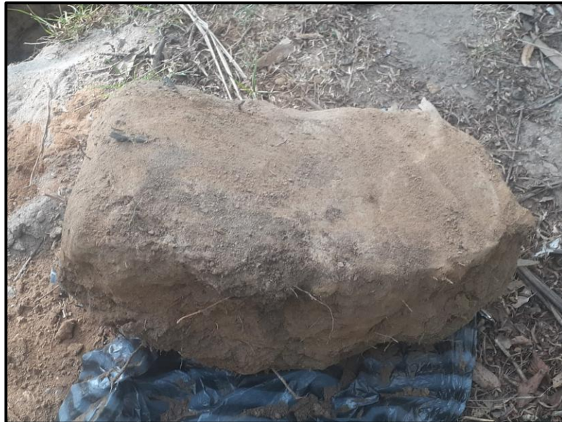
Figura 18 Obtención de la muestra inalterada de suelo
