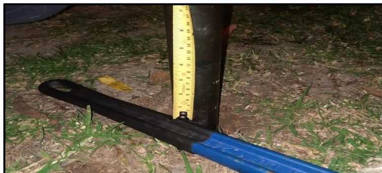
Figura 63 Rechazo en 5 cm de penetración.
