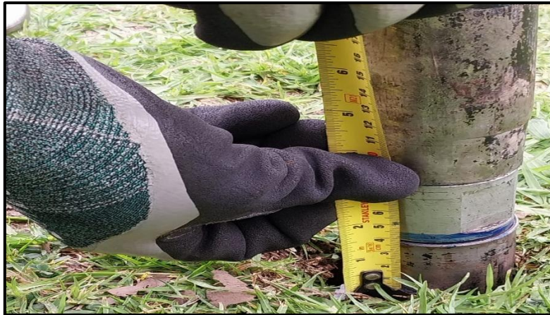
Figura 57 Rechazo en 11 cm de penetración
