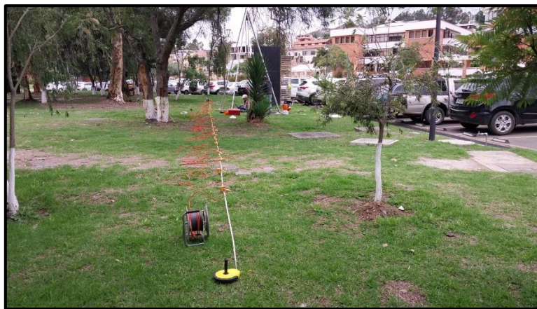
Figura 47 Colocación de geófonos y tendido del cable sísmico y trigger
