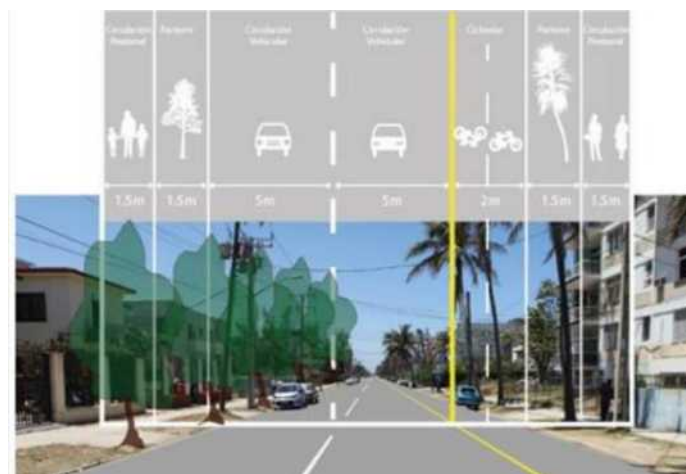
Figura 13: Sección de la calle 1ra del corredor urbano Oeste de la Habana
