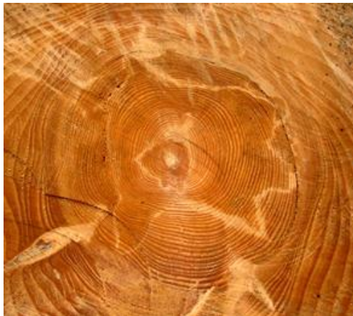
Figura 27. Estructura con Acebolladuras.
