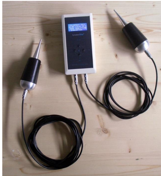
Figura 32. Equipos Portátiles para el Uso de las Técnicas de Ultrasonidos.
