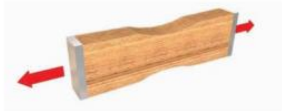
Figura 35. Esquema de Ensayo de Tracción Paralela a las Fibras.
