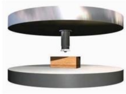
Figura 37. Esquema de Ensayo de Dureza.
