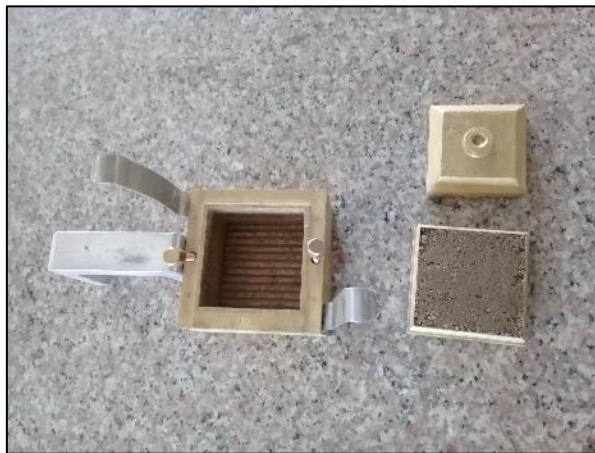
Figura 48. Muestra de suelo antes de ser ensayada por corte directo Elaborado: Autor
