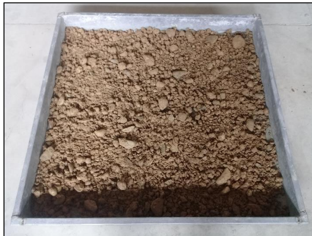
Figura 45. Muestra de suelo (Humedad Natural) obtenida en la ubicación del estribo Este. Elaborado: Autor
