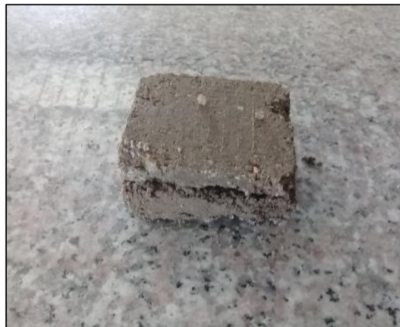
Figura 49. Muestra de suelo después de ser ensayada por corte directo Elaborado: Auto
