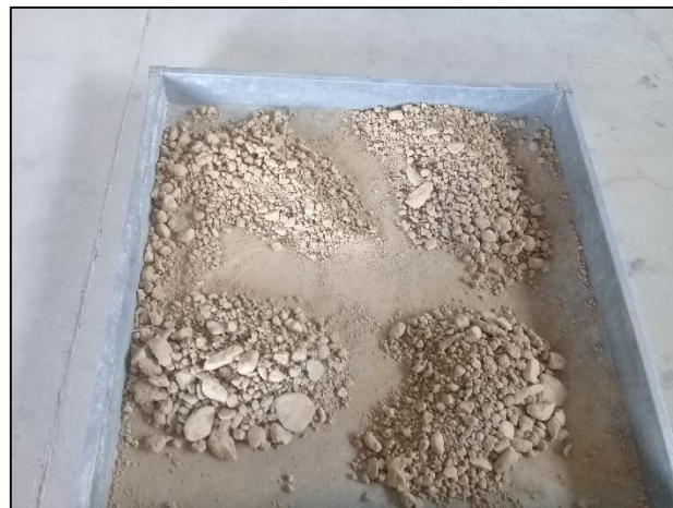
Figura 46. Muestra de suelo (luego del Secado) obtenida en la ubicación del estribo Oeste. Elaborado: Autor
