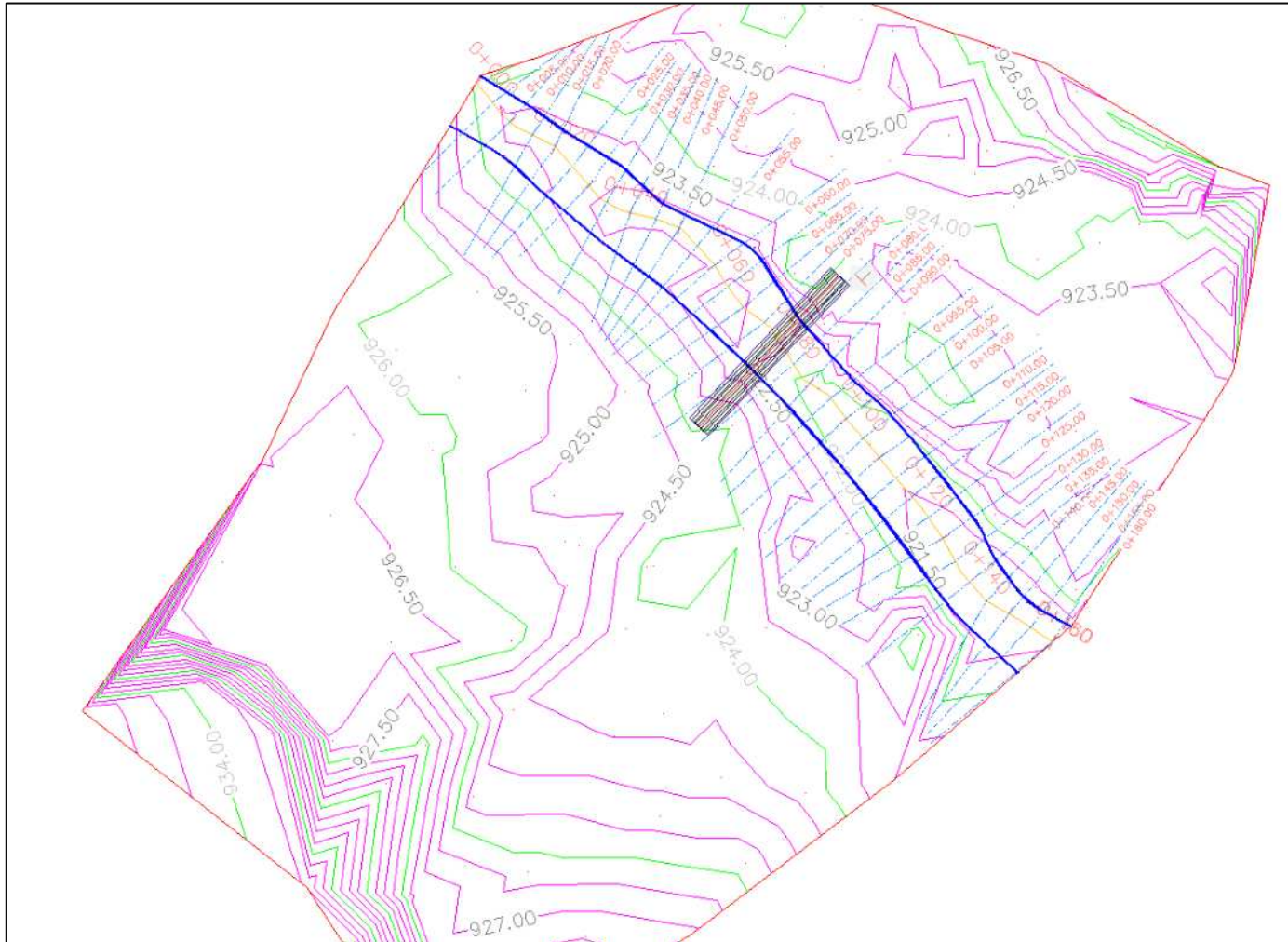
Figura 30. Levantamiento Topográfico y Secciones Transversales del Rio Chicaña.
