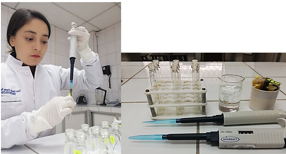
Fig 20 y 21. Dilución con pipeta en tubos de ensayo.
