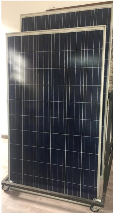
Figura 21 Panel solar fotovoltaico poli cristalino laboratorio UCACUE.
