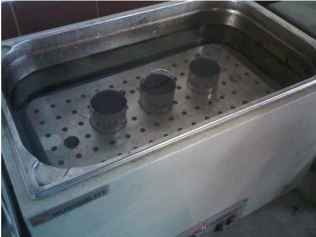
Fig. 20 Baño María con muestras a 60°C
