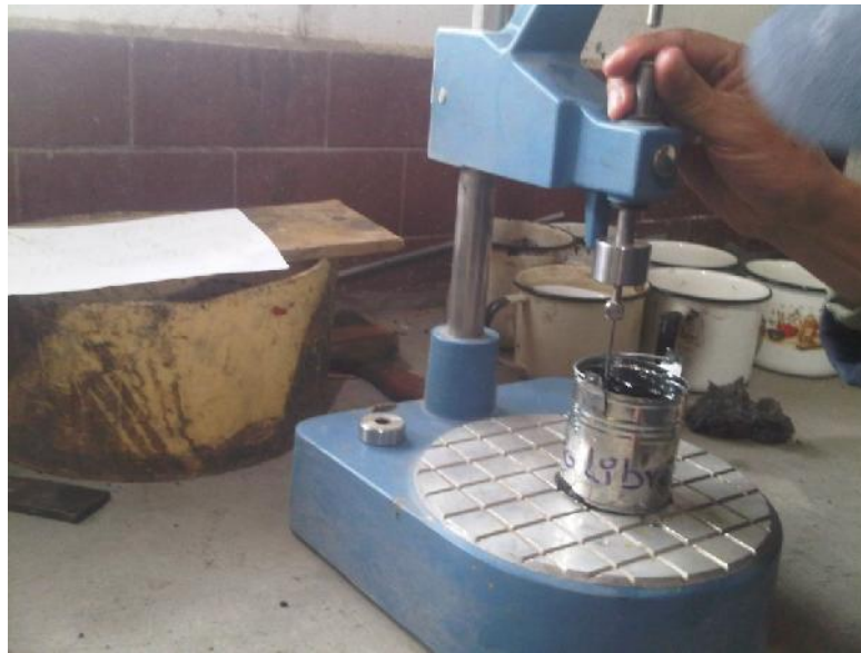
Fig. 21 Proceso de penetración
