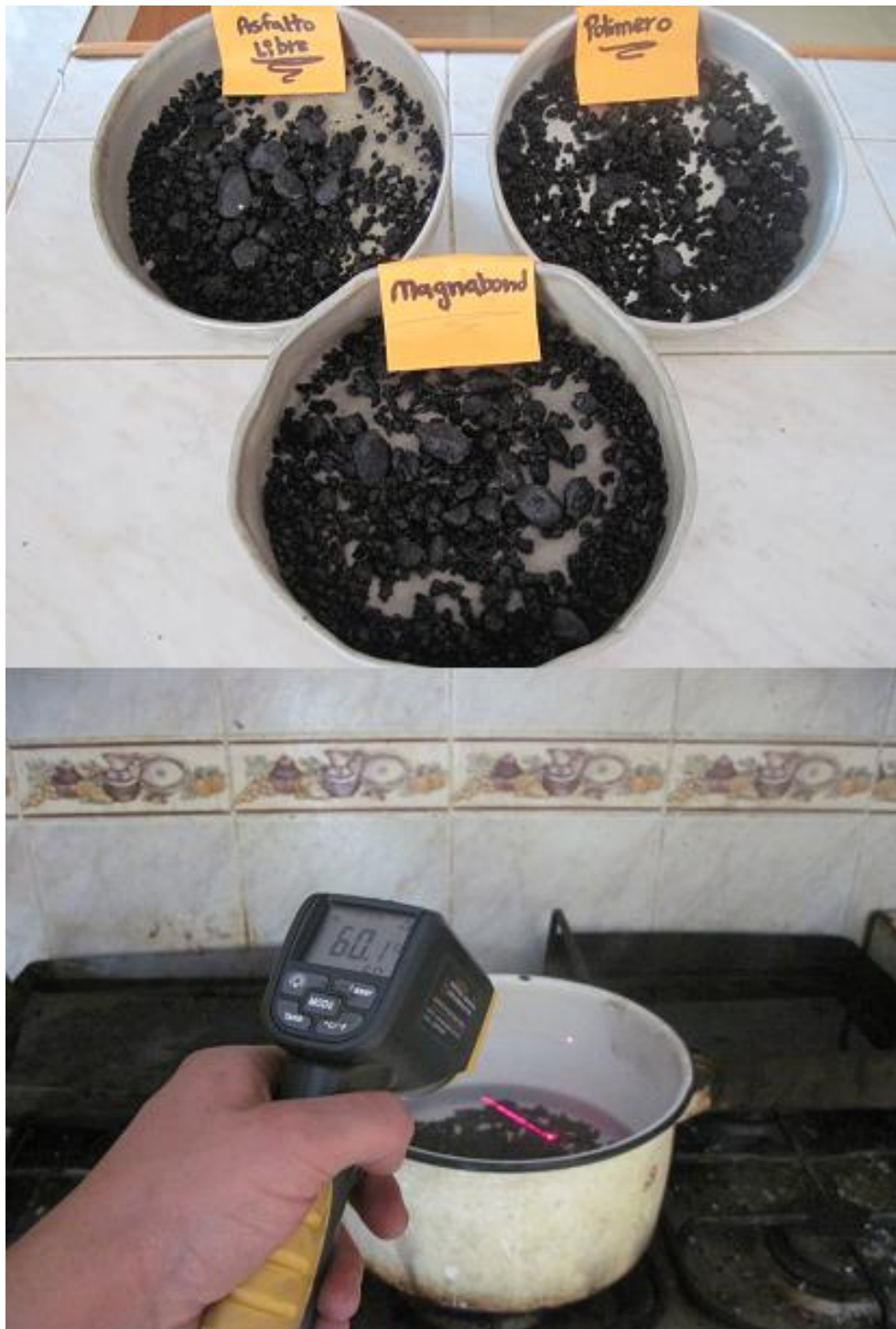
Fig. 17 Diferentes estados del proceso de peladura de la mezcla asfáltica Fuente: Ensayo de Laboratorio. Estados y temperatura a la cual se ensaya.
