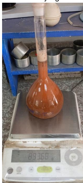
Masa: Picnómetro con muestra de residuos de ladrillo y agua
