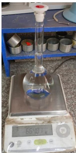
Masa: Picnómetro con agua hasta la marca
