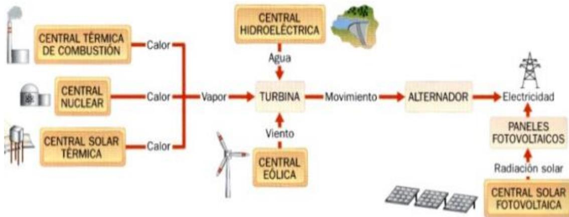
Figura 1 Diagrama de generación eléctrica mediante distintos tipos de fuentes o centrales eléctricas
