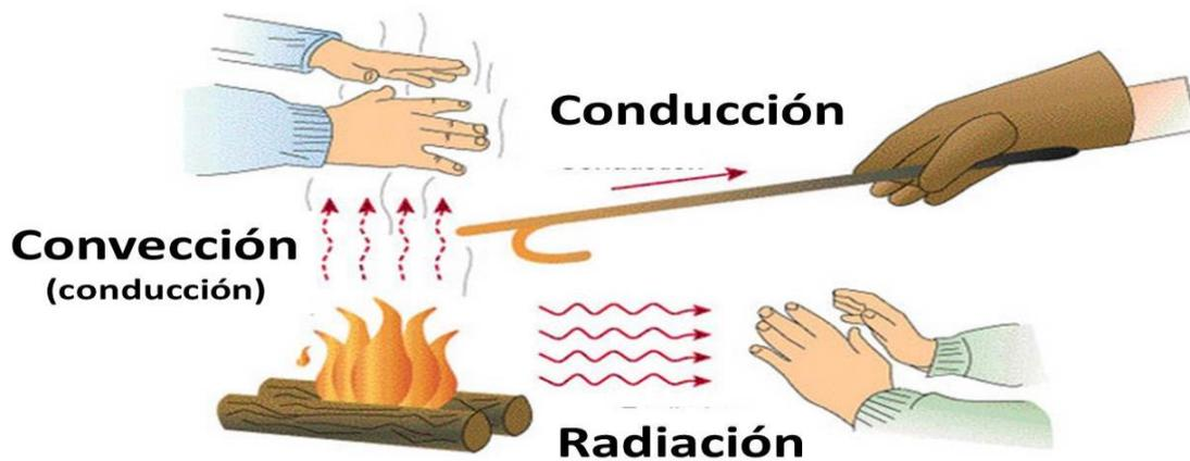
Figura 9 Métodos de transmisión de la energía térmica
