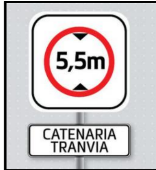
Figura 88: Señalización de "Catenaria Tranvía" fuente: https://twitter.com/tranvia_cuenca
