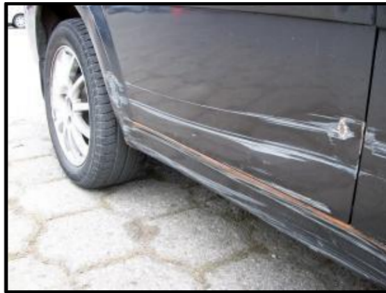
Figura 18: Rozamiento lateral de vehículo fuente: https://www.fullclasificados.ec
