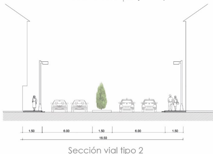
Figura 3.33 Sección vial de la Av. Huayna Cápac.
