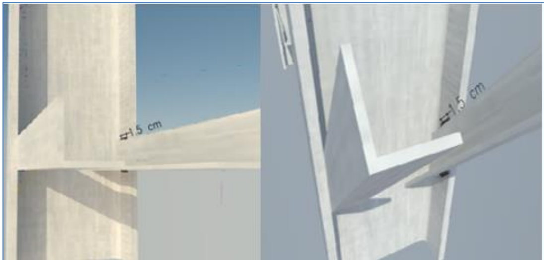
Ilustración 49. Soldadura en la celosía
