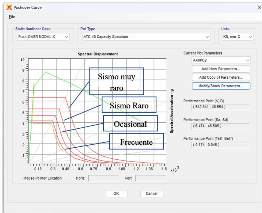
Ilustración 52 Relación Capacidad del pórtico vs Espectro de diseño con un sismo muy raro en SAP 2000 (Suelo Tipo C)
