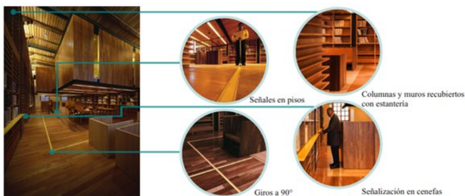
FIGURA 2.15: Señalizaciones de líneas en giros, columnas y muros perimetrales. Fuente: Rocha y Carrillo (2011). Recuperado de: https://n9.cl/psbv7
