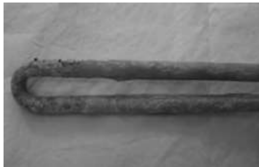
Figura 11. Deterioro de la tubería sin campo magnético Fuente: (Vidaurre, 2010)
