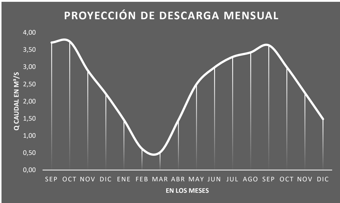
Figura 8. Caudales de descarga en función volumétrica acumulado de la presa Quingoyacu.
