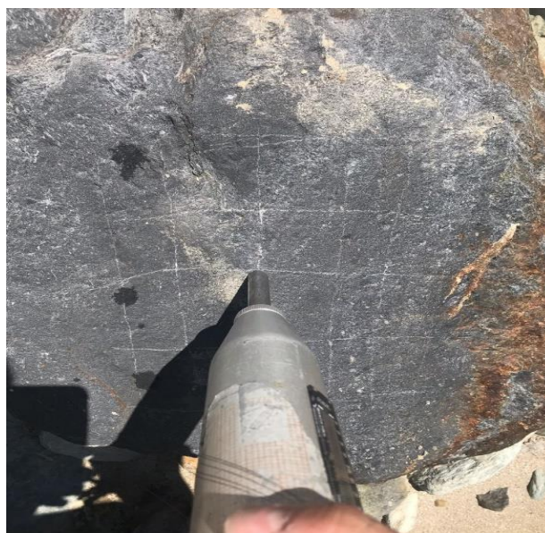
Figura 32. Cuadrícula de ambos márgenes para la utilización de esclerómetro. Elaborado por: Autor
