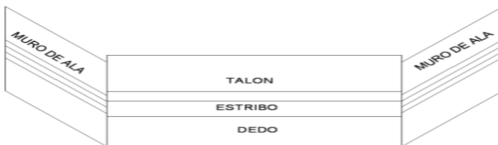
Figura 168. Vista superior del estribo con los muros ala. Elaborado por: Autor
