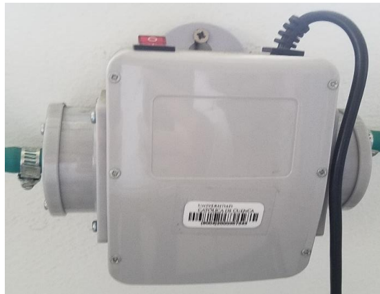
Fig. 15. Generador de presión de biogás
