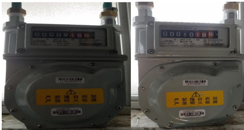
Fig. 63. Medición de 1\text{m}^3 de biogás
