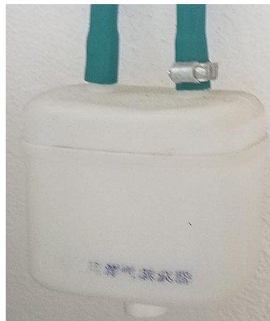
Fig. 12. Filtro de vapor de agua (H 2 O)
