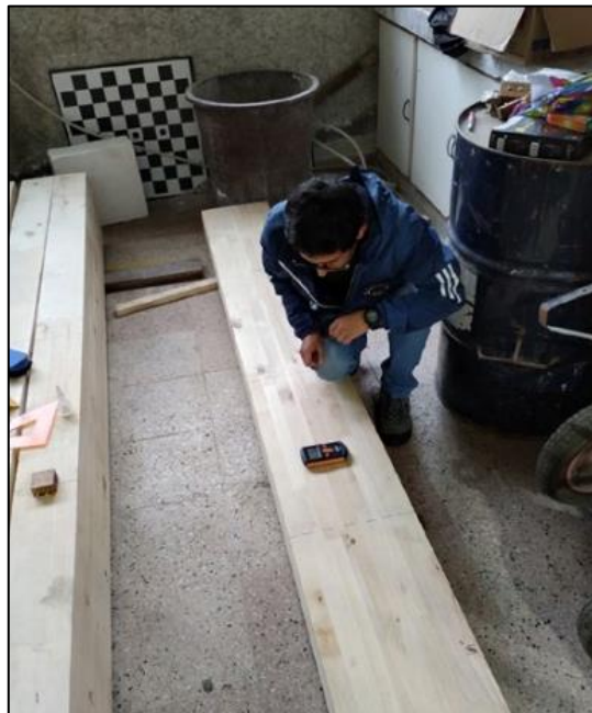
Figura 6: Medición de contenido de humedad
