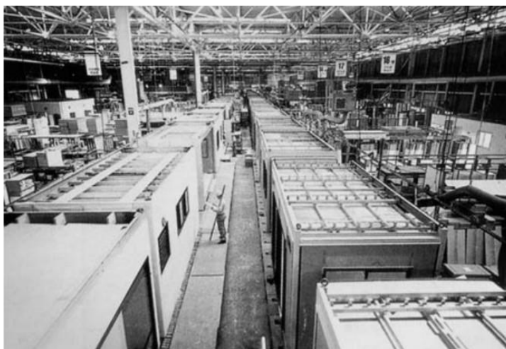
Figura 5: Línea de montaje de módulos residenciales en Japón
