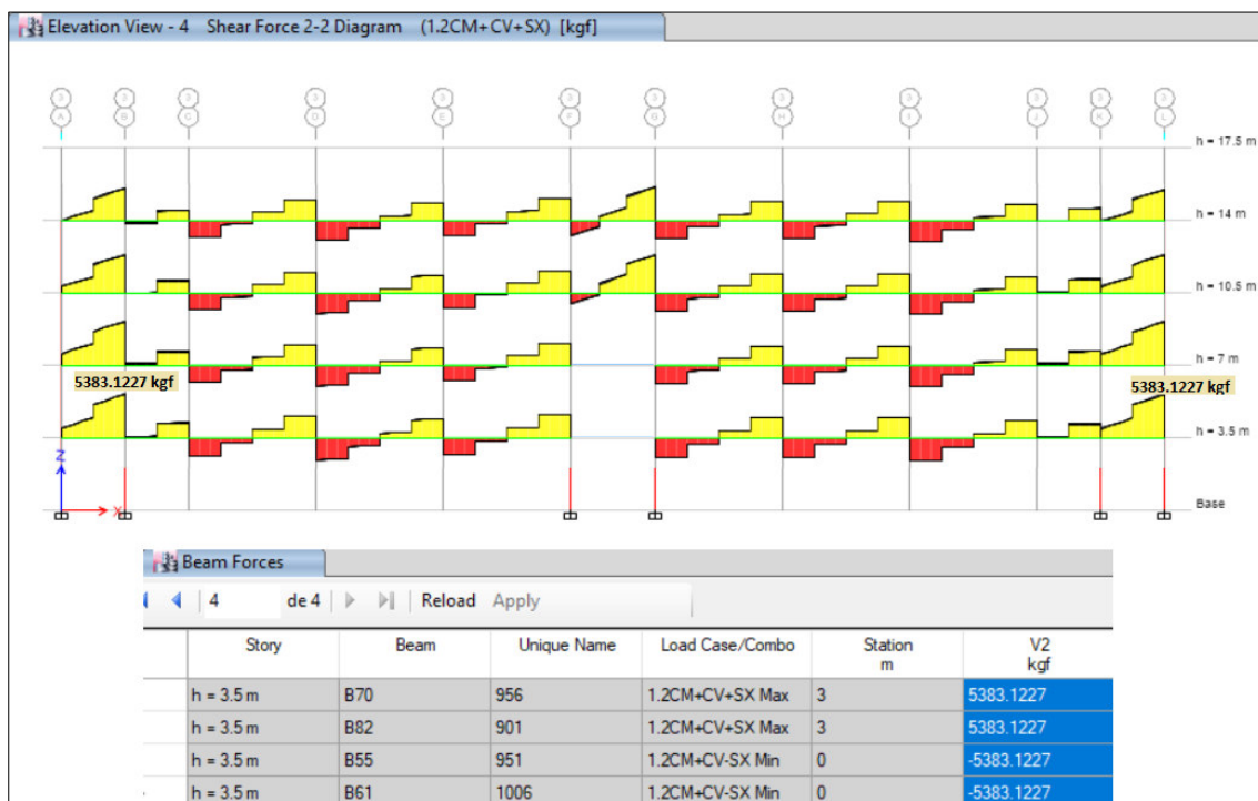
Figura 87. Diagrama de fuerzas cortantes en vigas IPE 240.
