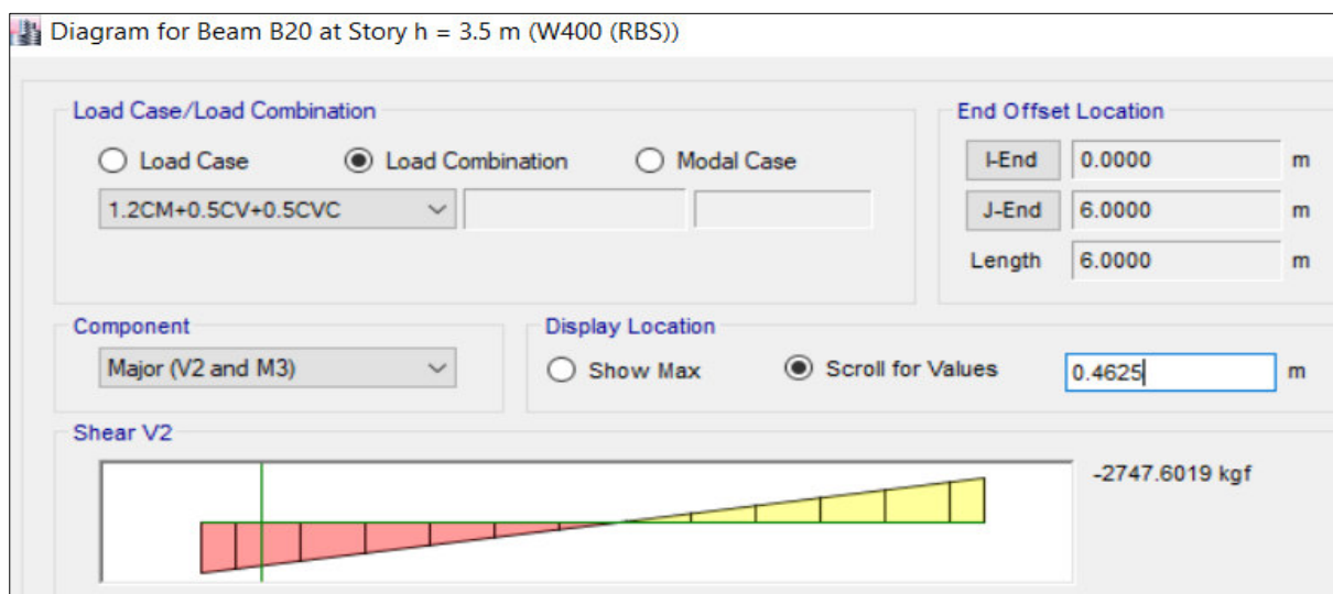
Figura 138. Diagrama de fuerzas cortantes en vigas de sección reducida W 400.
