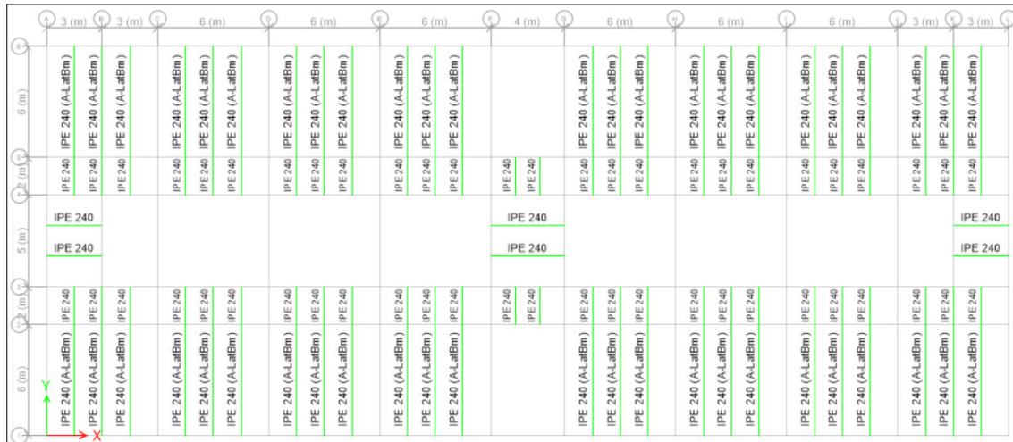
Figura 72. Distribución de vigas secundarias.
