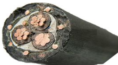
Figura 52. Cable concéntrico 3 x 8, utilizado en la instalación de los paneles fotovoltaicos. Fuente: Los autores.
