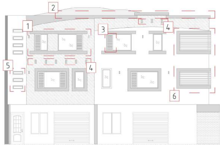
Figura 139: Identificación de elementos más representativos que componen la fachada.
