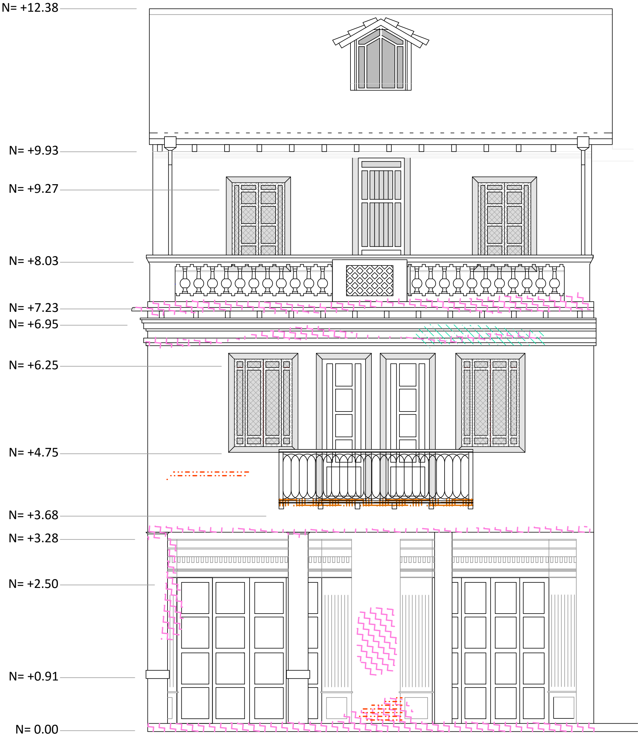
ELEVACION FRONTAL DAÑOS
