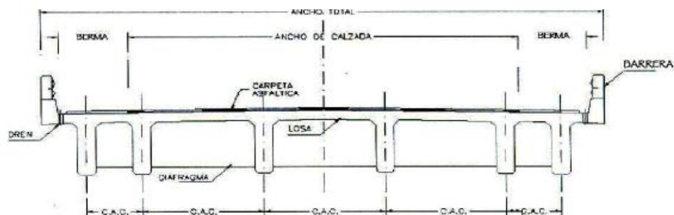
Figura 2. 2: Superestructura de un puente (Fuente: Rodríguez Serquén, 2012)
