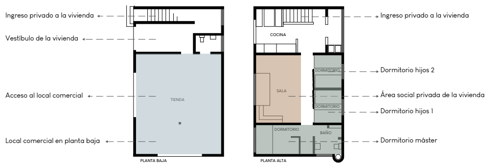
Figura 1.53: Plantas arquitectónicas de la Vivienda Obrera, Juan Legarreta a escala 1:50, con la distribución de los espacios.
