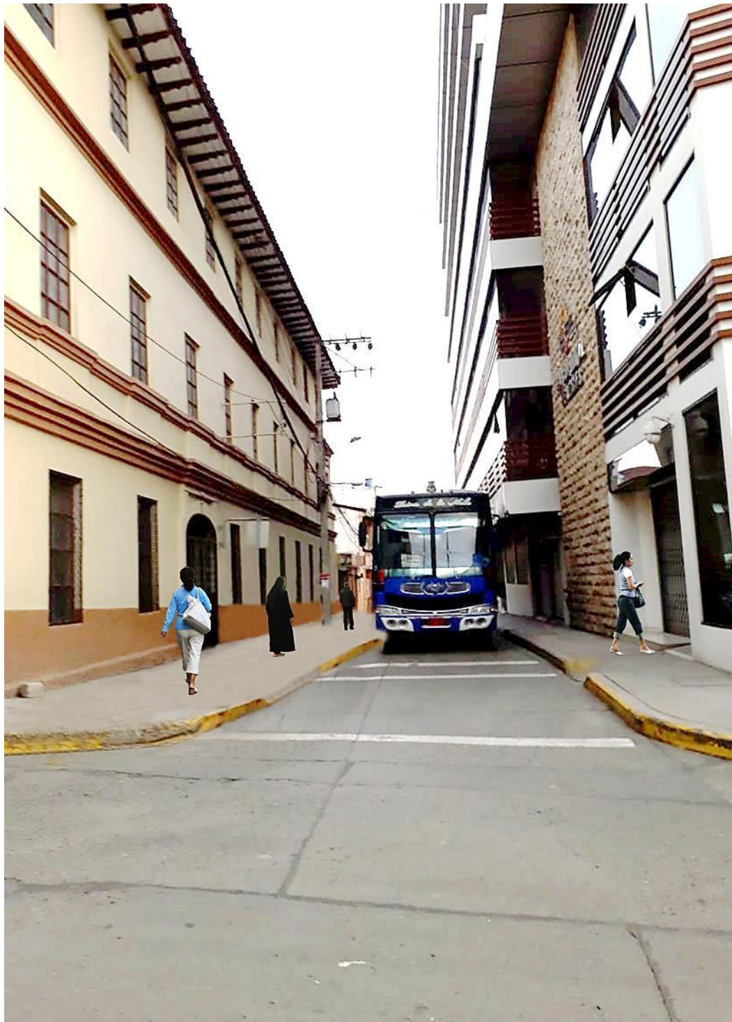
Ilustración 16. Ensanchamiento de la acera para generar un solo carril que dé prioridad a la circulación del transporte público
