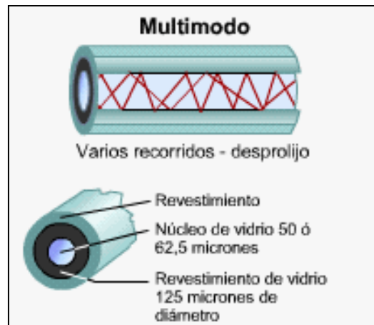
Figura 1 .Estructura de la fibra multimodo.
