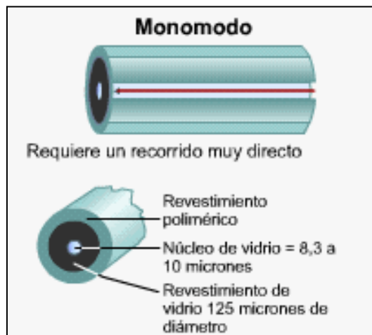
Figura 3. Estructura de la fibra monomodo.
